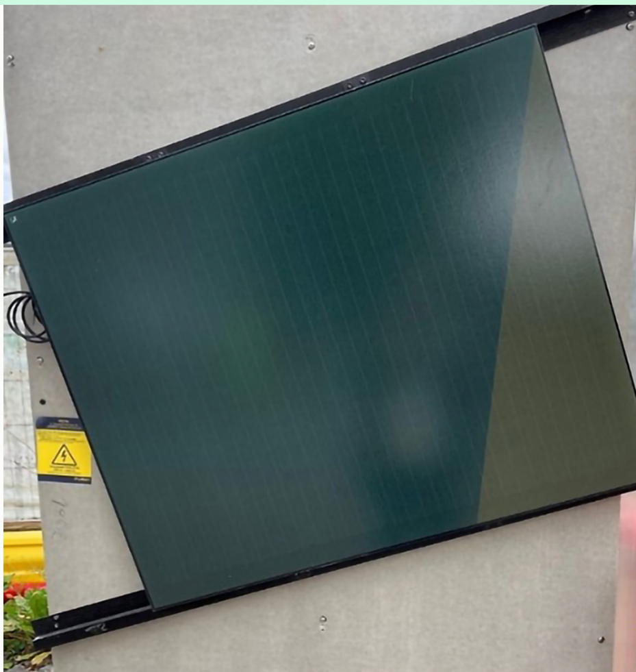
Et av de tofargede solcellepanelene som er testet på byggeplassen. Ill.: Kontur og Spinn Arkitekter
